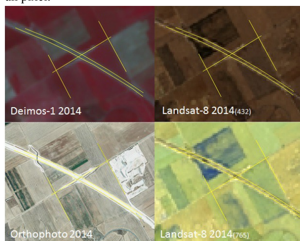
Figura 2. Coherencia en la georreferenciación de imágenes Landsat-8 y Deimos-1 en Zona de Villanubla (Valladolid) Escala 1:25.000
